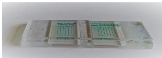
Figura 1: Câmara Mc Master para a contagem de ovos por grama de fezes. Quantificação do nível de infeção por ovos de endoparasitas. (Fonte: Vera Bavinck, Fair Poultry)
