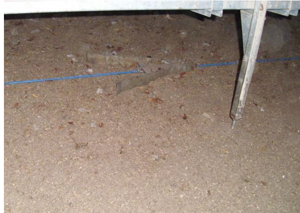
Figura 2: Raspador de arena automático (Fuente: Mona Giersberg, Universidad de Utrecht)
