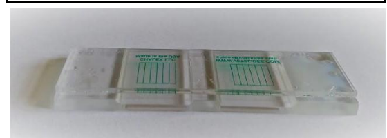
Figura 1: Cámara de conteo McMaster. Cuantificación de la infección por huevos de gusanos (Fuente: Fair Poultry)
