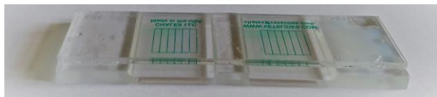
Figure 1: Chambre de comptage Mc Master. Quantification de l'infection par les œufs de vers (Source: Fair Poultry)
